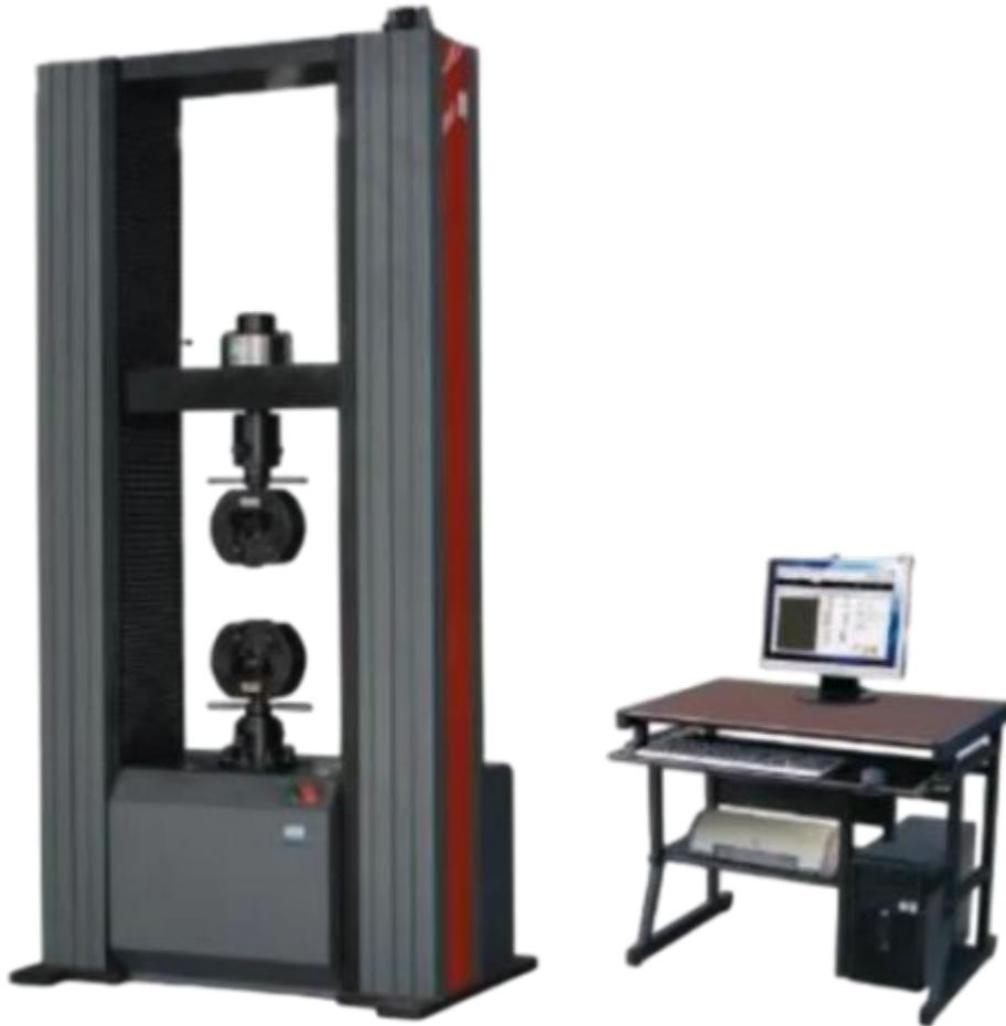
**Mesin uji universal LD-200KN** dapat digunakan untuk menguji karet, film plastik, kabel, kain, kertas, papan aluminium dan sebagainya. Ini sangat ideal untuk pengujian tegangan, kompresi, tekukan / kelenturan, dan geser berkapasitas tinggi, mesin ini dijamin memenuhi persyaratan relatif ISO, ASTM, JIN, GB, dan banyak standar pengujian lainnya.
